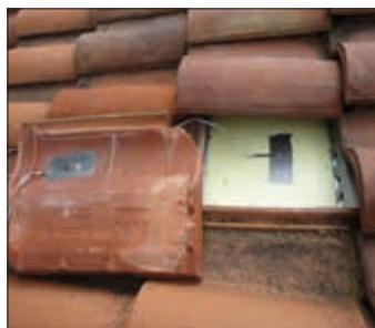
Foto 1 - Posa delle sonde di temperatura sulla copertura senza alluminio
